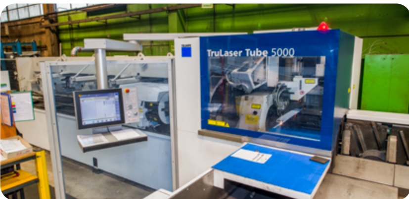
Découpe laser automatique 2D et 3D
